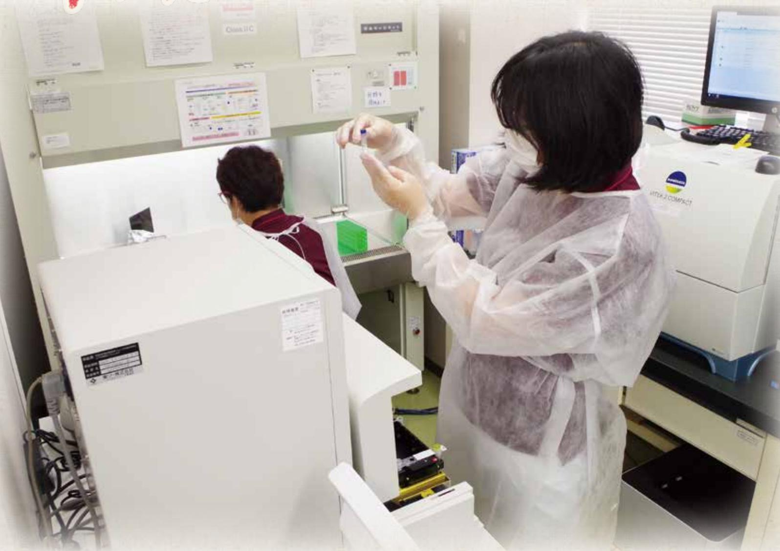
核酸増幅検査装置を使用したPCR検査法を行っている様子
